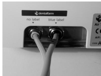
3. Collegare il tubo di alimentazione dell'aria (rilsan o nylon diametro 6x4) al raccordo posto sul lato sinistro del gruppo filtro-riduttore (A)
